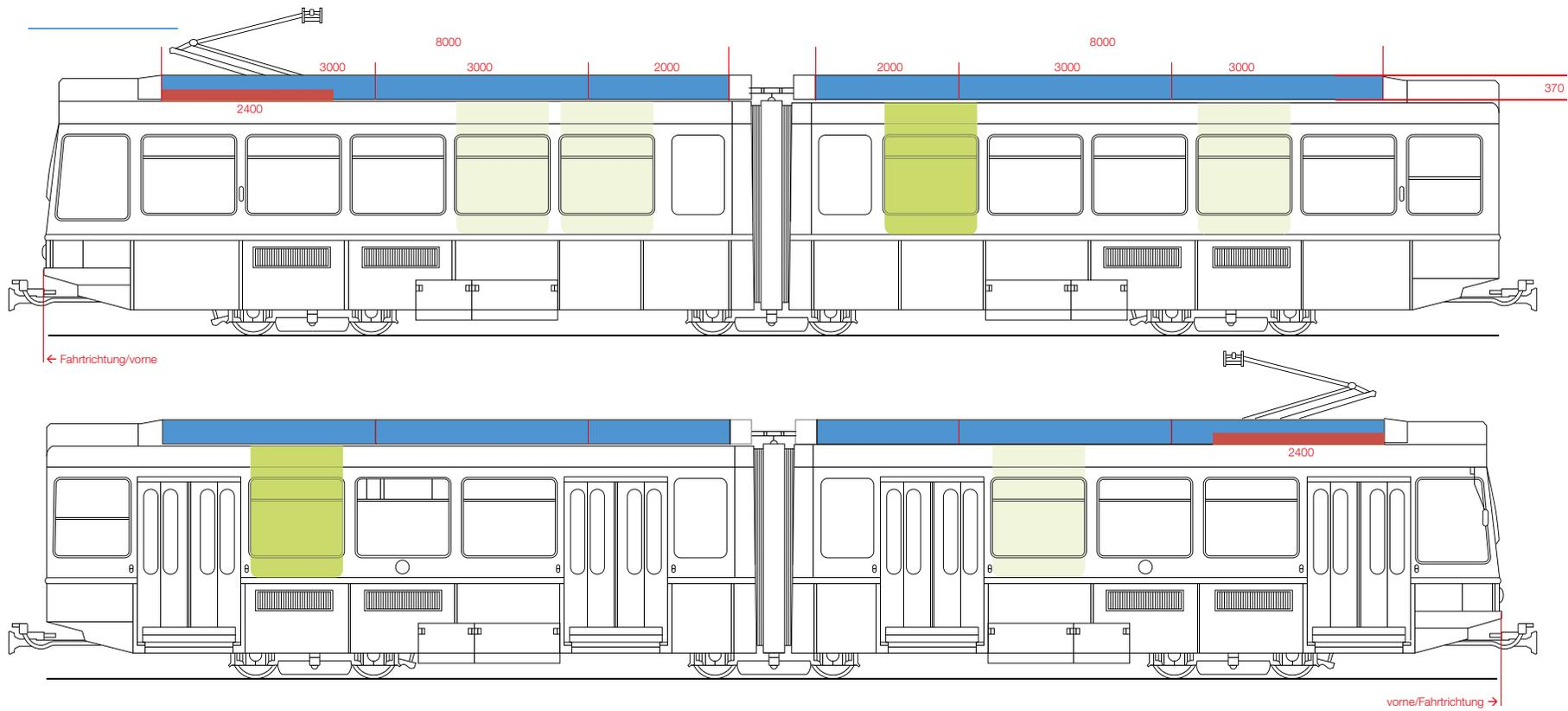
Auf einer Länge von 2400 mm von vorne dürfen keine 3D-Elemente montiert werden.
