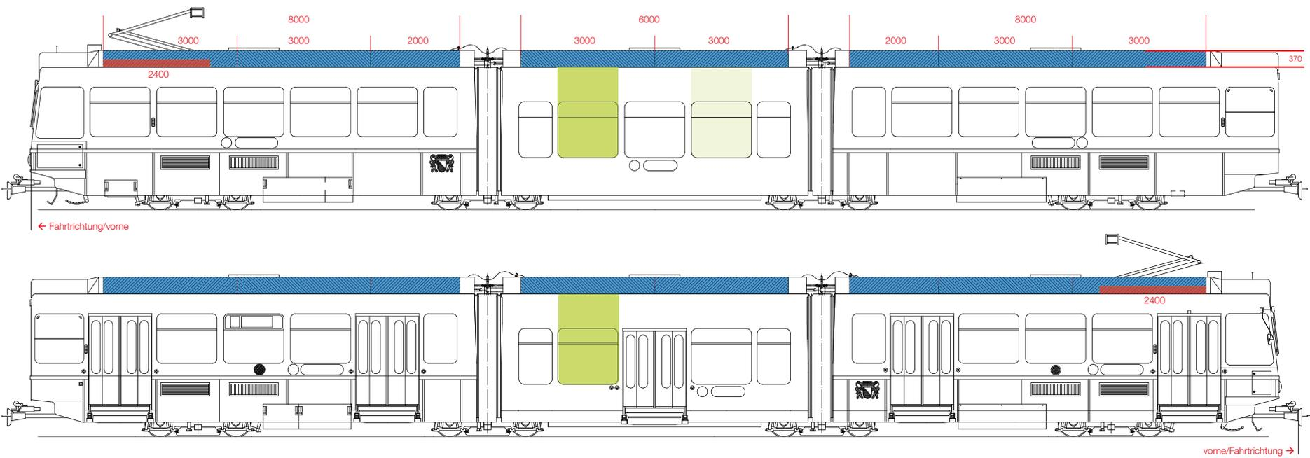
**■** Auf einer Länge von 2400 mm von vorne dürfen keine 3D-Elemente montiert werden.
